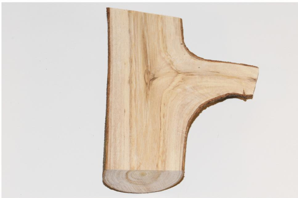
Abbildung 108: Längsschnitt, Astansatz
