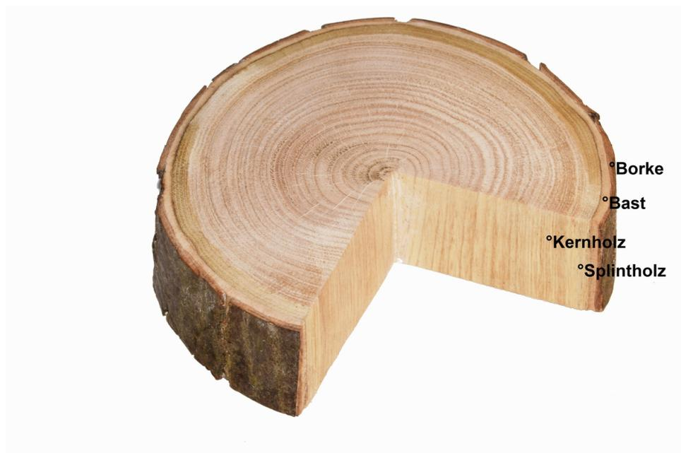
Abbildung 105: Querschnitt und Ausschnitt eines Edelkastanienstammes
